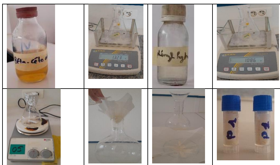
Figure II.4: les étapes de préparation de 3-méthyl-1-phényl-4H-pyrazol-5-one (originale.2023).
