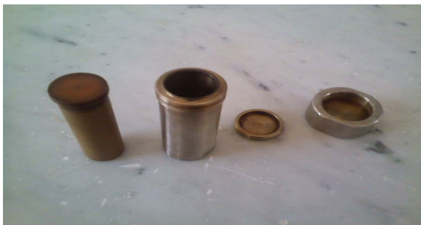
Figure.IX . Photo d'un autoclave de 40 ml et de sa chemise en Téflon
