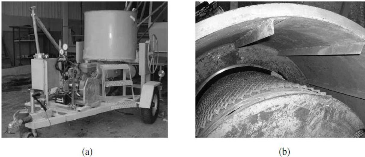
Figure 2-10. a) vue générale du rhéomètre Cemagref-IMG, b) cylindres intérieur et extérieur [22]
