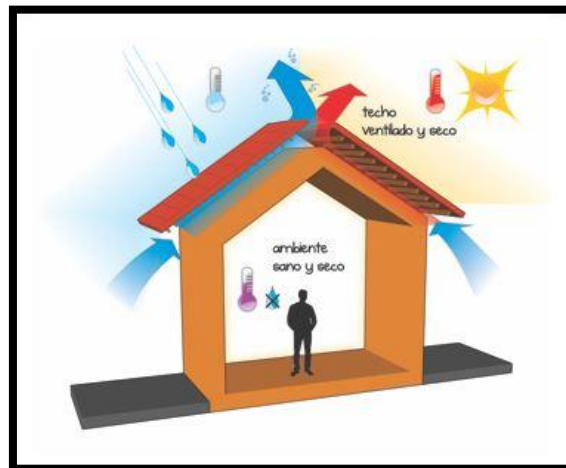
Figure 43 : system de ventilation par la toiture ventilé
