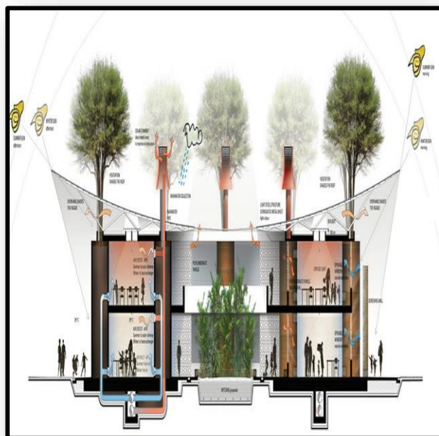
Figure 34 : Coupe schématique présente le système de chauffage et refroidissement.
