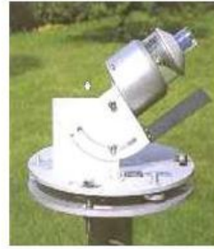
Figure (A-03) : héliographe à fibres optique.
