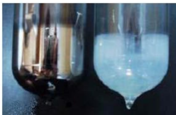
Figure II.16: Le bout du tube est argenté si le vide est effectif, sinon il devient blanc
