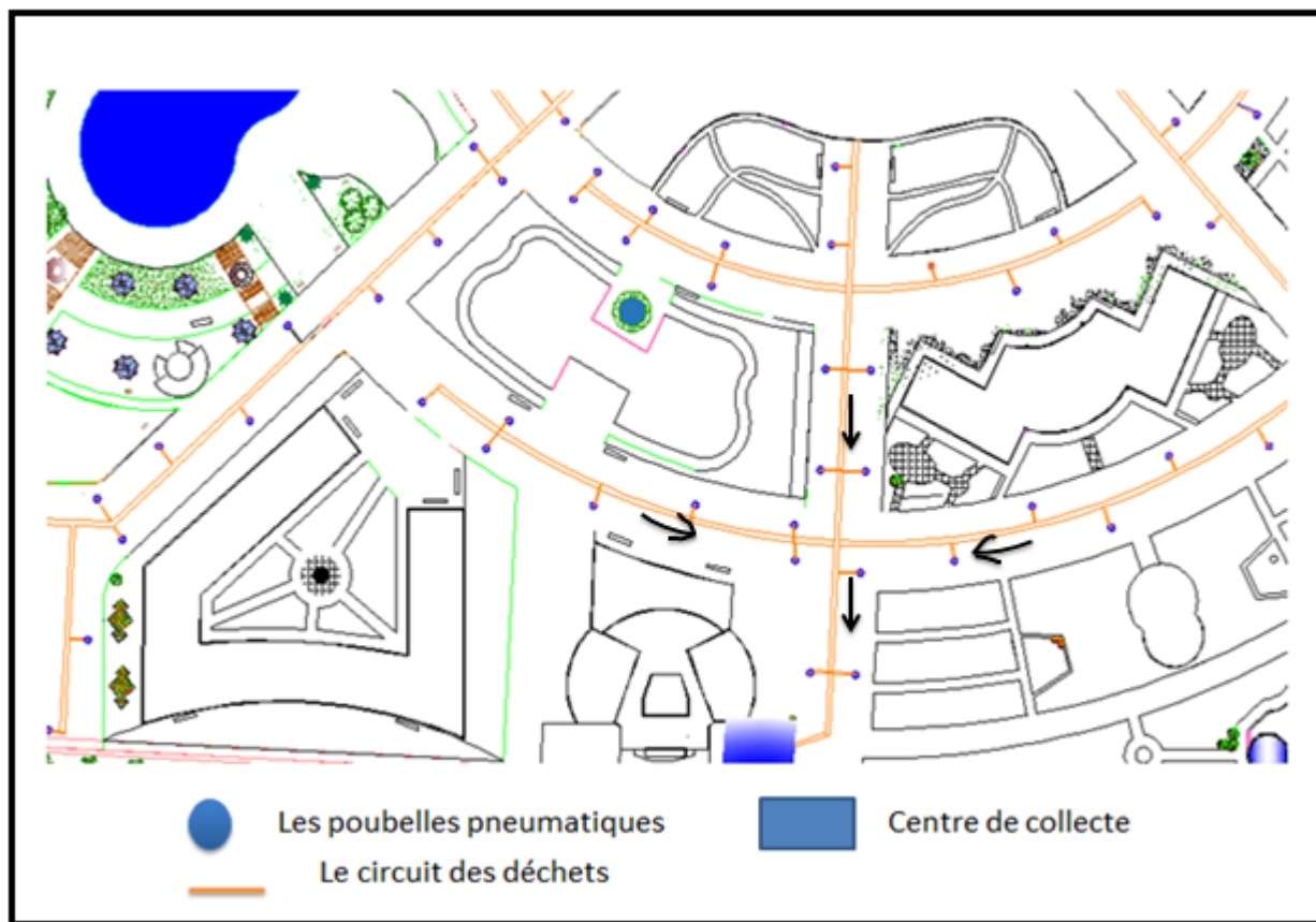
Figure n° 15 : représente l'emplacement des poubelles pneumatiques dans le quartier Source : auteur
