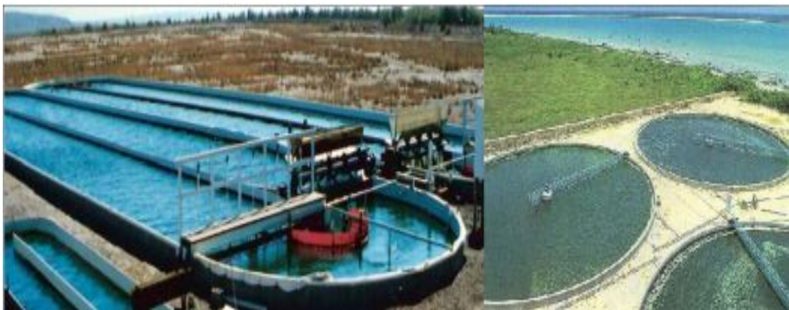
Figure I.4 : Bassins de culture de micro-algues. A gauche : Bassin en boucle fermée. A droite : bassins circulaires d'environ 500 m 2 , production de chlorelle
