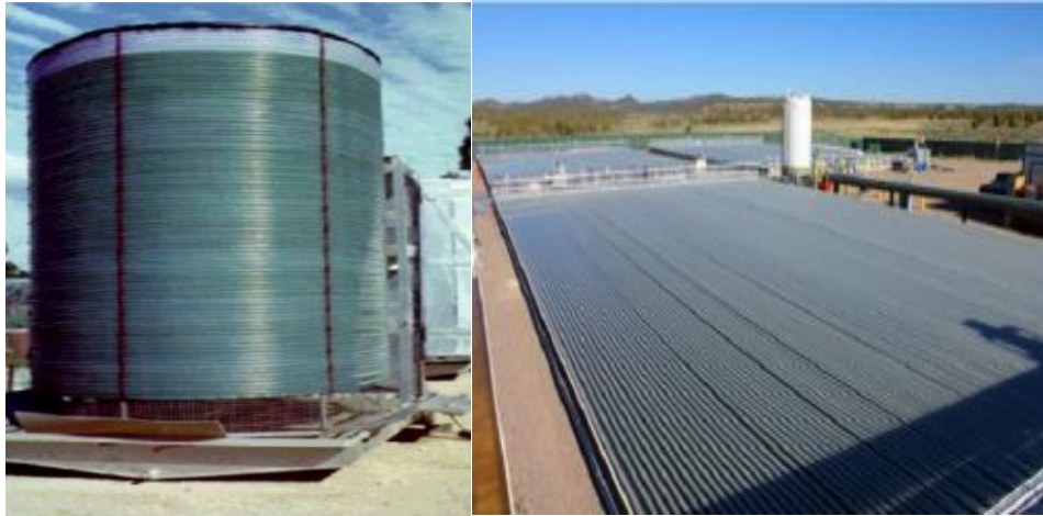
Figure I.5 : Photographies de différentes installations de PBR tubulaires. A gauche : PBR hélicoïdal, vertical. A droite : PBR tubulaire horizontal immergé dans l'eau
