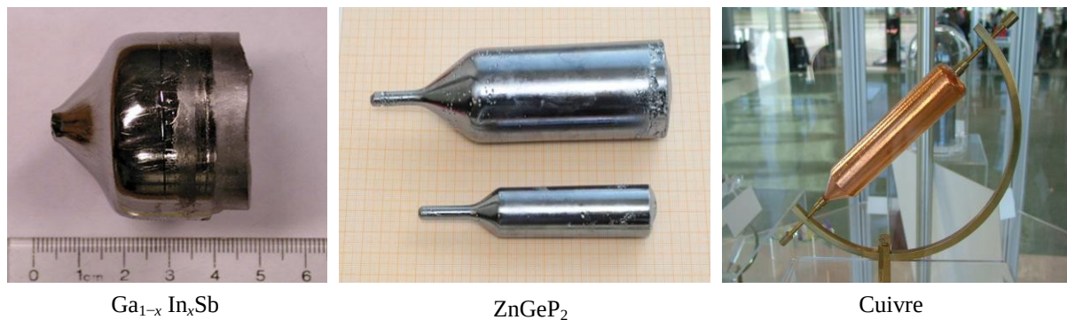
Figure I.3 : Lingots élaborés par la technique de Bridgman.
