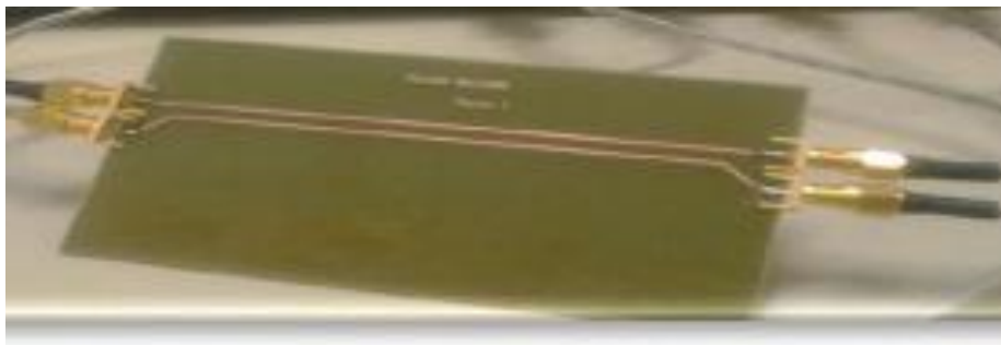
Figure III. 1: Photographie d'une carte PCB avec deux lignes microruban couplées
