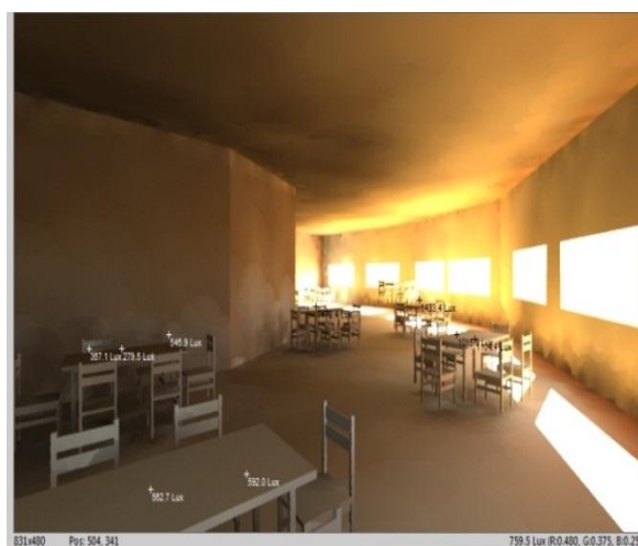
Figure 25 : Mesure de niveau d'éclairement à ciel couvert source : auteur
