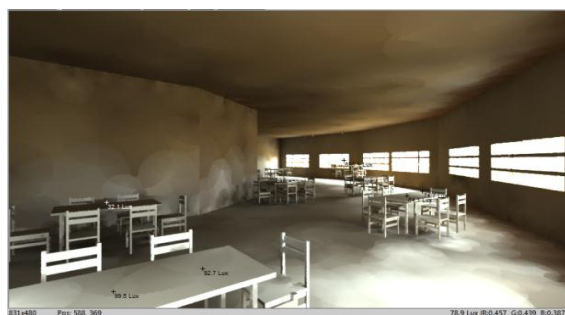
Figure 47 : Mesure de niveau d'éclairement à ciel couvert
