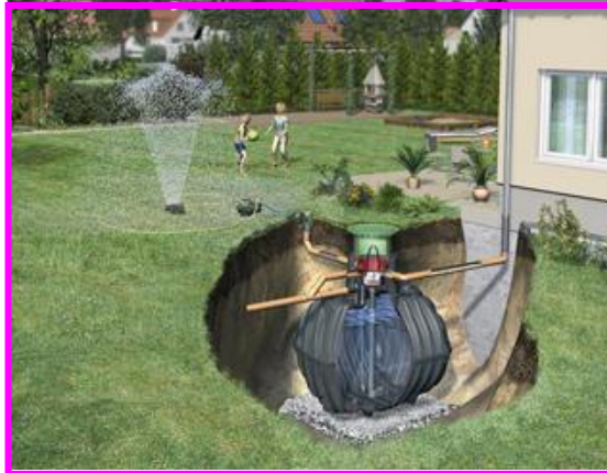
Figure.v.57: La cuve enterrée
