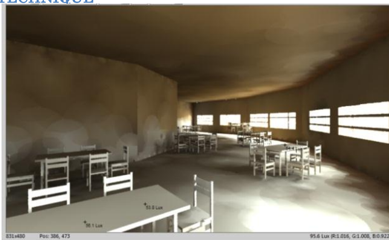
Figure 42 : Mesure de niveau d'éclairement à ciel couvert Source : auteur
