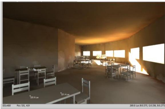
Figure 19 : Mesure de niveau d'éclairement à ciel couvert
