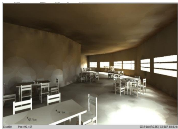
Figure 44 : Mesure de niveau d'éclairement à ciel couvert source : auteur
