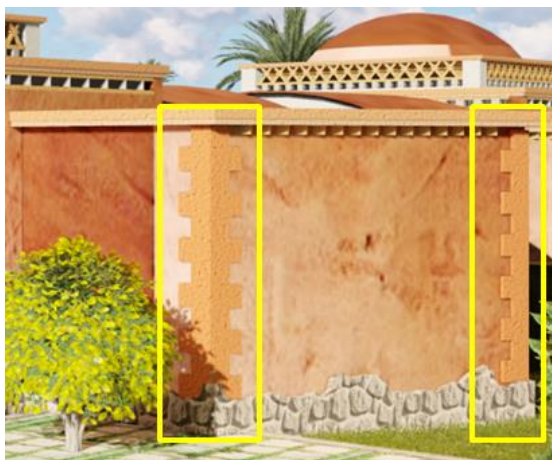
Fig. III.B.9 : l'appareillage au niveau d'intersection des murs /l'auteur
