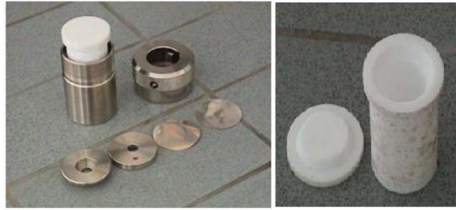
Figure I.3 : Le corps en acier inoxydable et la chemise en téflon de l'autoclave.
