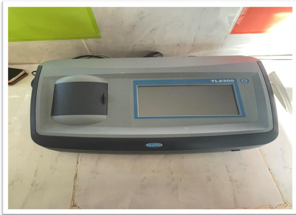
Figure 17: Turbidimètre de paillasse HACH pour mesurer la turbidité (HACH COMPANY TL2300)
