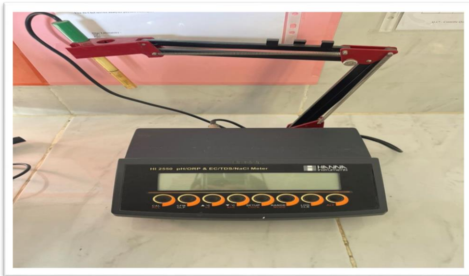
Figure 16 : Conductimètre pour mesurer la conductivité et TDS (HANNA)
