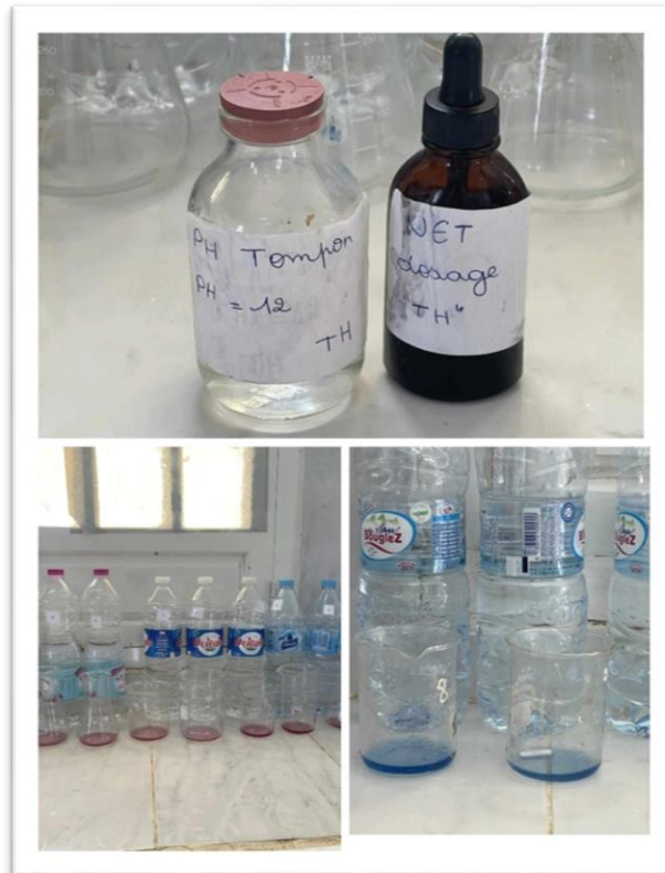
Figure 18 : Dosage de la dureté totale (titre hydrotimétrique TH)
