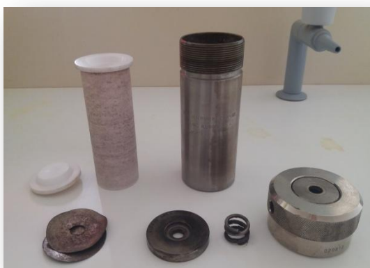
Figure II.2 : Le corps en acier inoxydable et la chemise en téflon de l'autoclave.
