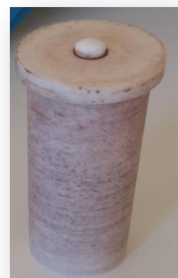
Figure II.2 : Le corps en acier inoxydable et la chemise en téflon de l'autoclave.
