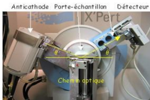
Figure II.3 : (A) Diffractomètre X'PertPHILIPS , (B) Spectromètre de poudres.
