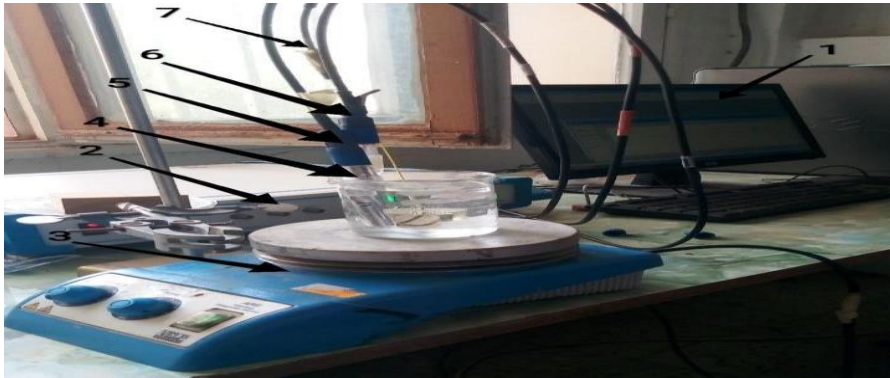
Figure III.16. Dispositif Expérimental de la technique potentiostatique
