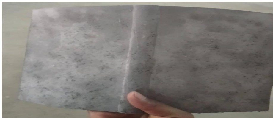
Figure III.9. Plaque de pipeline X60 avec soudure
