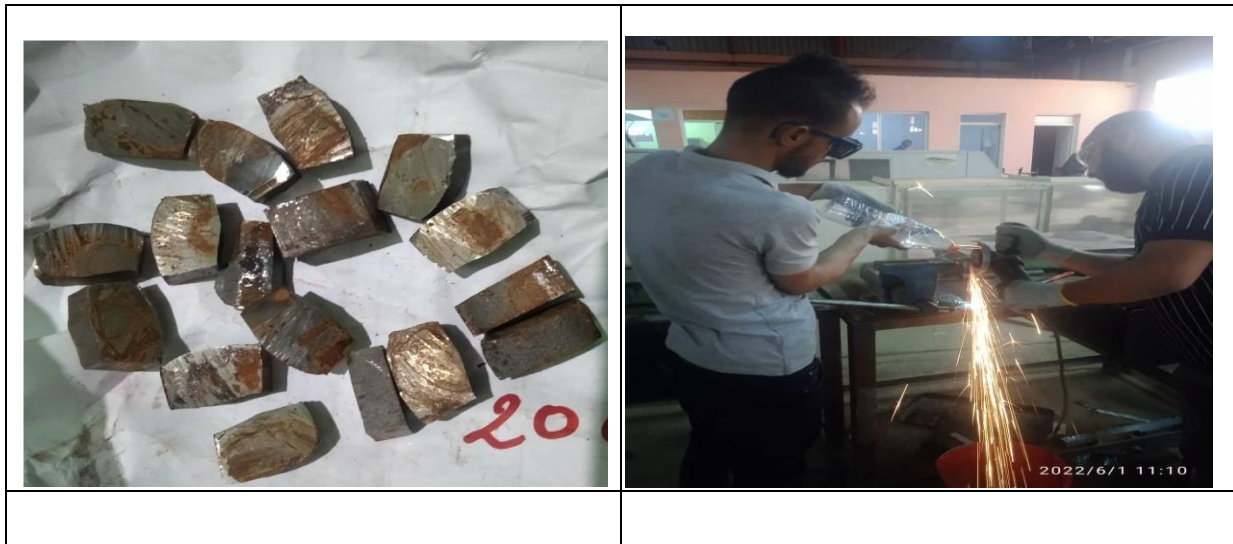
Figure III.12. Echantillons découper par une tronçonneuse
