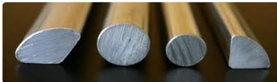
Figure (1.3) - Les conducteurs aluminium massifs ronds ou sectoriels.
