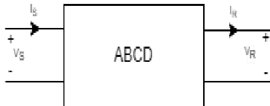
. Figure (2.2) - La ligne de transmission représentée par un quadripôle
