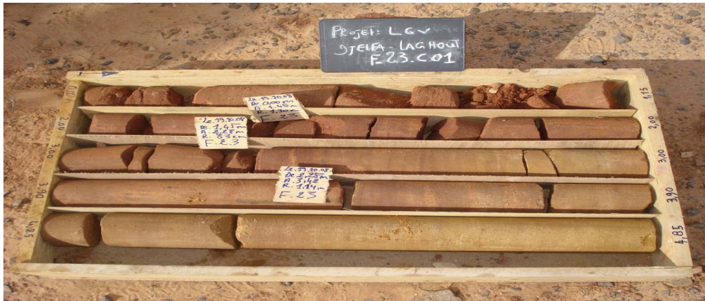
Figure V.5 : Caisse N° 01 (0,00 à 4,85 m)
