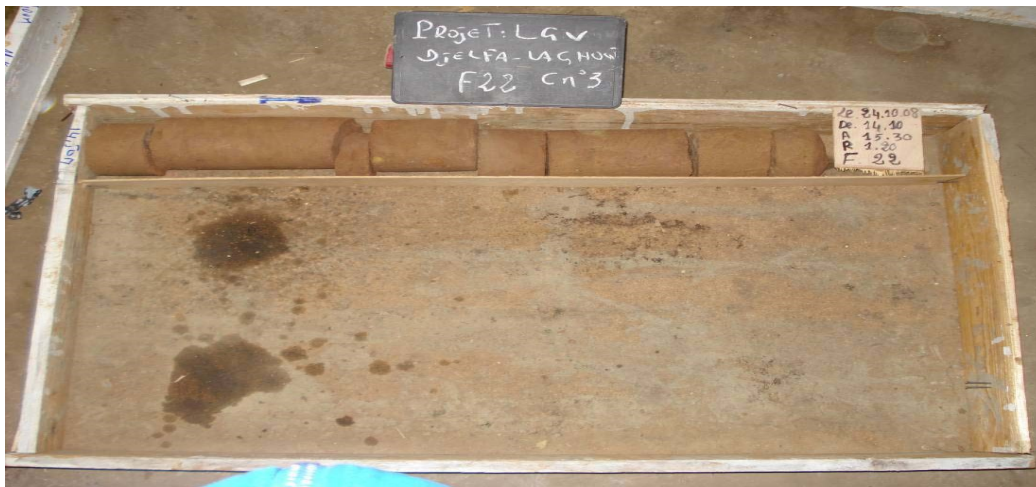
Figure V.4 : Caisse N° 03 (14,50 à 15,30 m)
