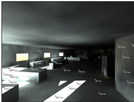
Figure N25 : Niveau d'éclairément intérieur, Source : Auteur
