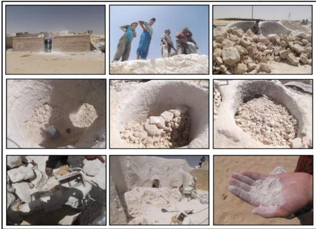
الصورة 4. طريقة تحضير الجبس التقليدي المستعمل في البناء بالحي العتيق الاعشاش المصاعبة بالوادي
