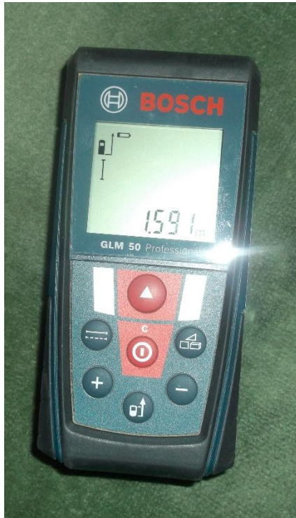
الصورة 05 : تمثل جهاز القياس الليزري المستعمل في المسجد
