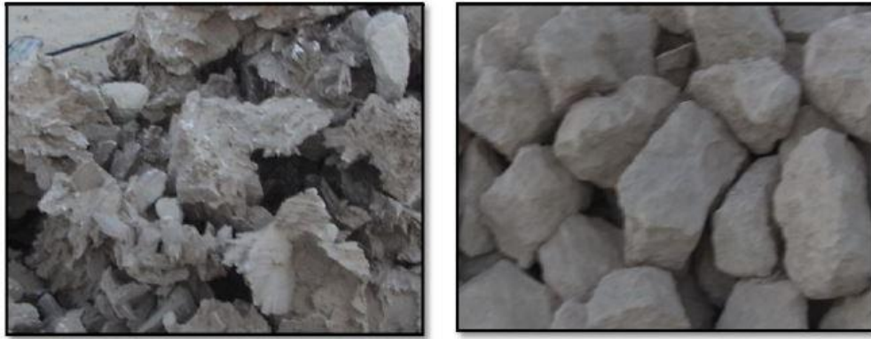
الصورة 6. حجر اللوس و الصلاجة المستعمل في البناء بالحي العتيق الاعشاش المصاعبة بالوادي
