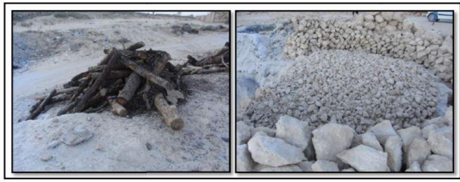
الشكل 1. طريقة تحضير الجبس التقليدي المستعمل في البناء بالحي العتيق الاعشاش
