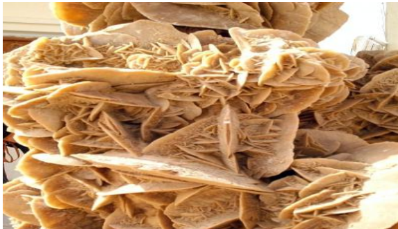
الصورة 6. حجر اللوس و الصلاجة المستعمل في البناء بالحي العتيق الاعشاش المصاعبة بالوادي
