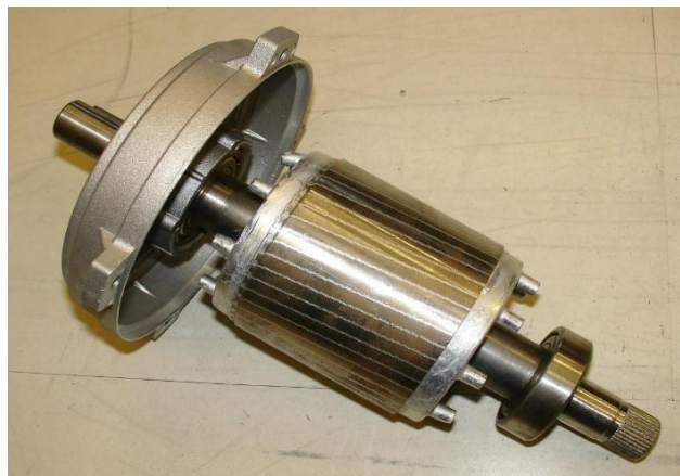
Figure I-5 : rotor à cage d'un moteur asynchrone.
