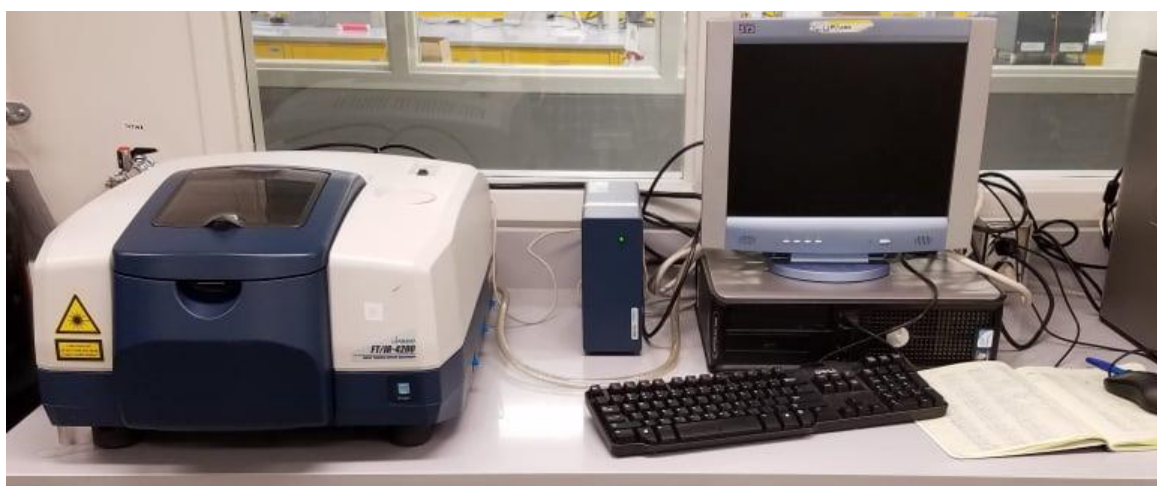
Figure III-1 : Spectromètre Jasco FT/IR-4200 assisté par ordinateur
