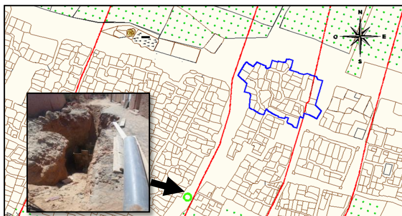
Figure. II.15 : situation des travaux d'assainissement dans le ksar
