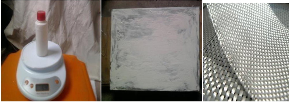
Figure 8: Les éléments à préparer pour l'élaboration de notre composite: pesage du durcisseur, le moule pain par le gel-coat, la fibre de verre.[3]
