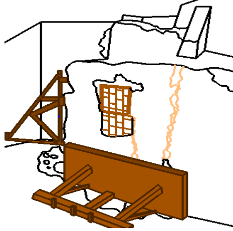
صورة رقم 96: توضح طريقة تدعيم الجدار بعوارض خشبية المصدر: إعداد الطالبة
