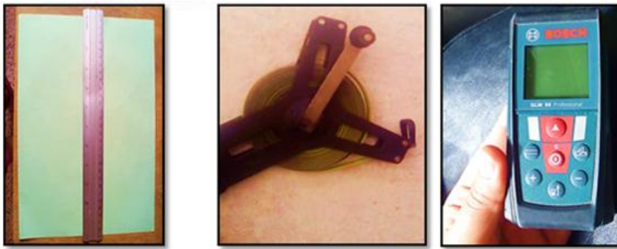
صورة رقم 52: توضح الأدوات المستعملة في الرفع المعماري للمبنى (الديكامتر 20م، مسطرة قياس 30سم)
