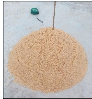
Figure 86 : Mesure d'hauteur du cône de sable
