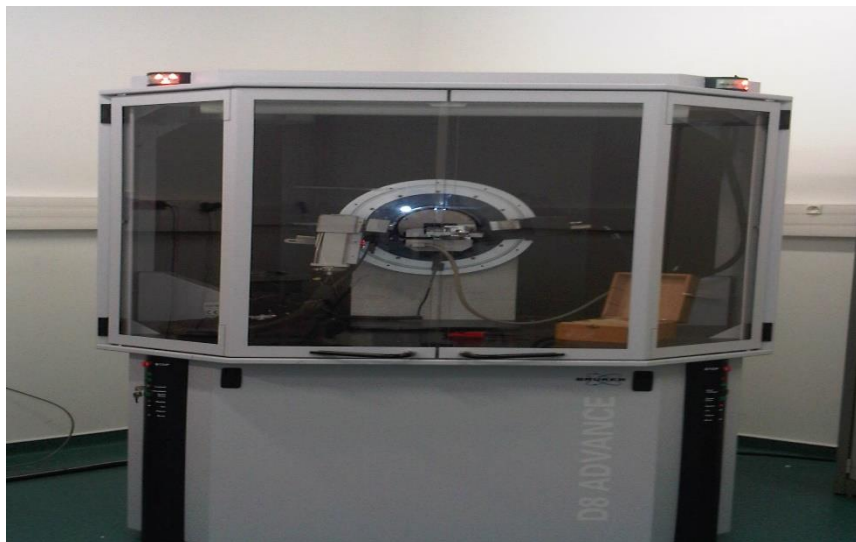
Figure II-3 : Image de l'appareil diffractomètre Brüker AXS D8
