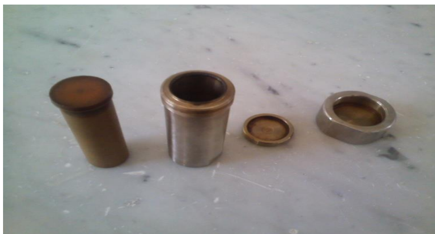
Figure III-1 : Autoclave de 40 ml et sa chemise en Téflon
