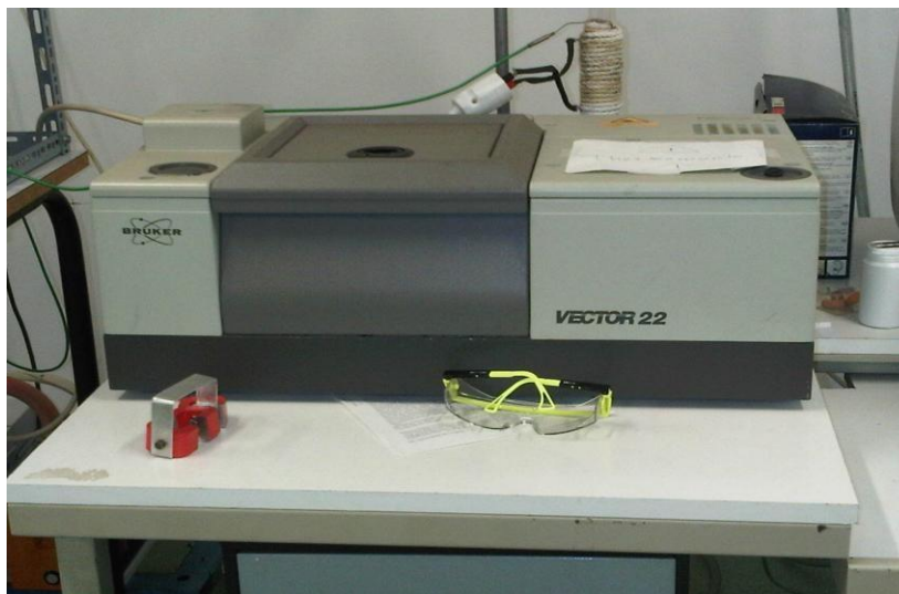
Figure II-1 : Appareil de la spectroscopie de l'IR.
