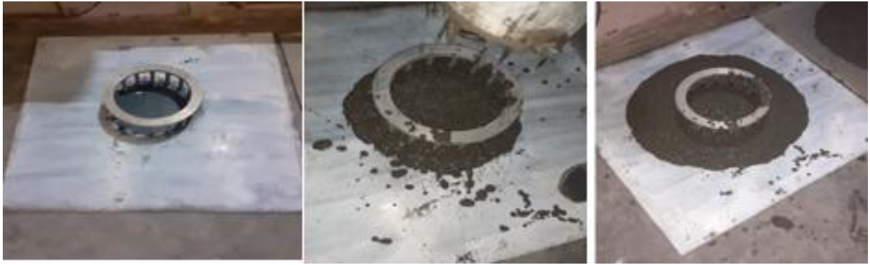
Figure 3.6. Essai de la couronne J (J-Ring test)
