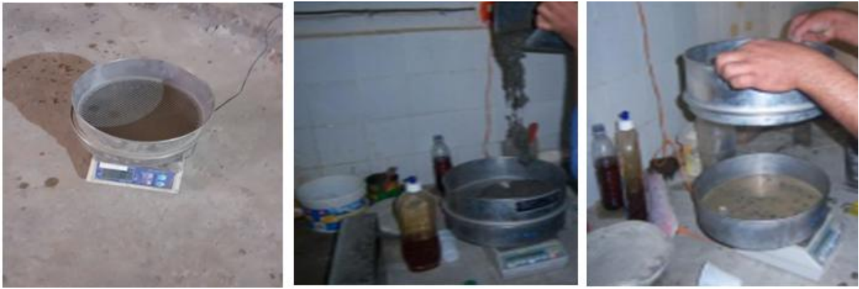
Figure 3.7. Essai de stabilité au tamis
