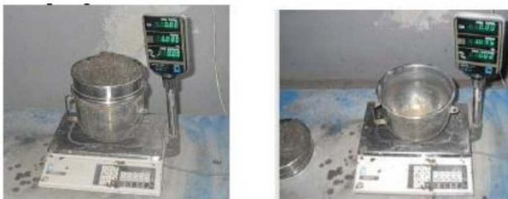
Figure 1.4. Représentation de l'essai de stabilité au tamis
