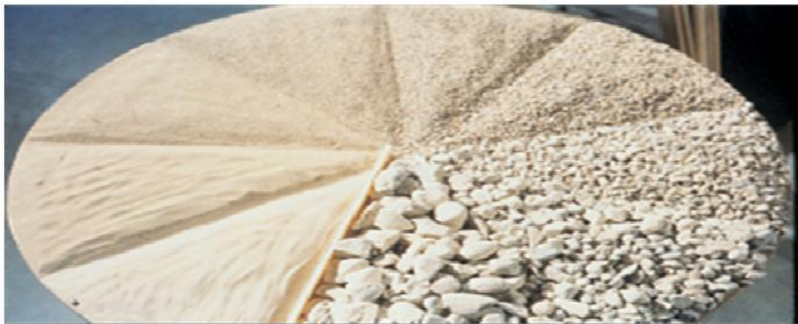
Figure 2.1. Éventail de grosseurs de granulats utilisés dans le béton [10, 11, 12]
