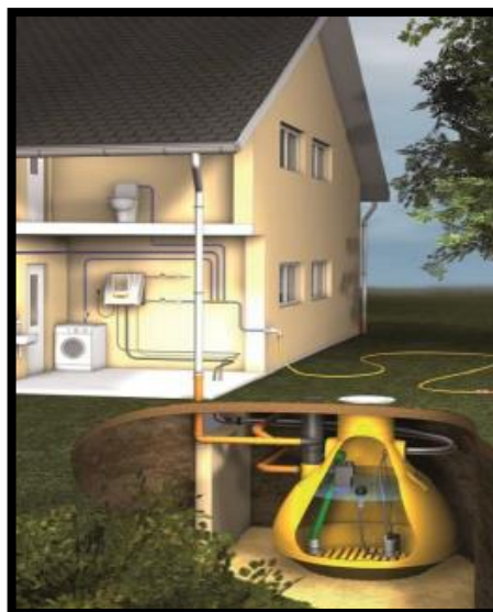
Figure 85 : Photo Récupération des eaux pluviales
