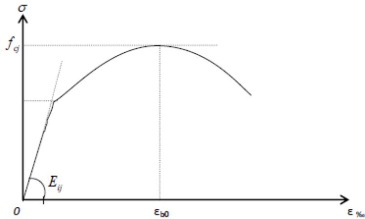
Fig II-2 : Diagramme de déformations du béton.
