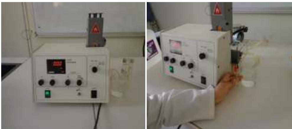
Figure5. La détermination de taux de potassium par le spectrophotomètre à flamme.
