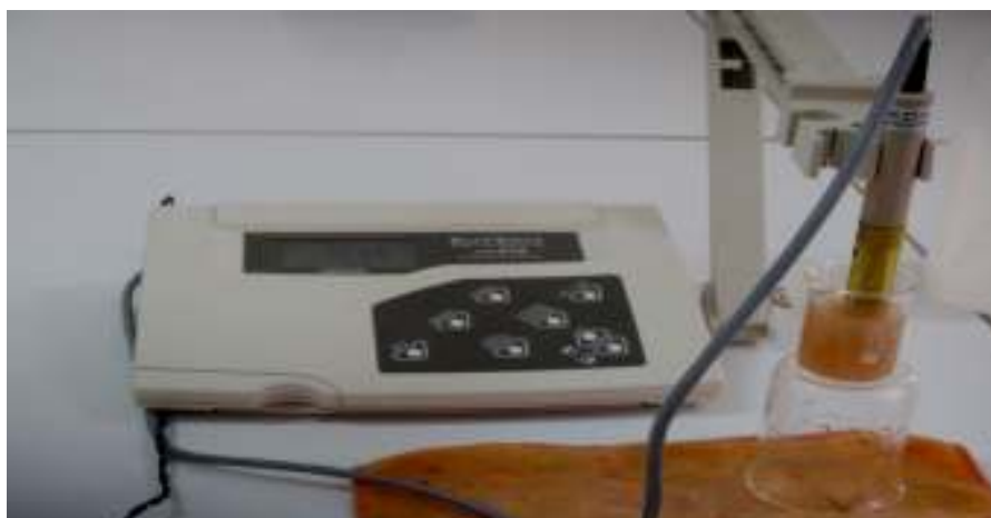
Figure 8. Mesure de conductivité électrique (CE).
