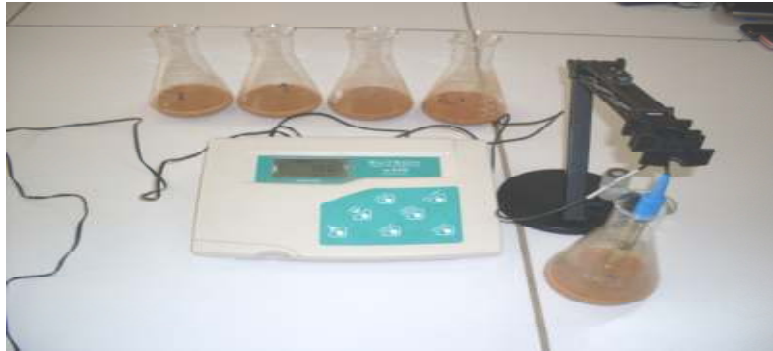
Figure 7. Mesure de pH par pH-mètre.
