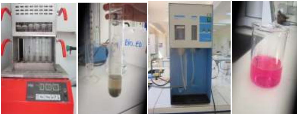
Figure 3. La détermination de la matière azotée par le dosage de l'azote totale, selon méthode de Kjeldhal.
