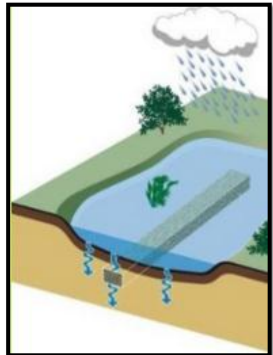
Figure6 : Cas d'un bassin d'infiltration Source : http://www.guidebatimentdurable.brussels/fr/vue-d-ensemble-des-dispositifs.html?IDC=5352
