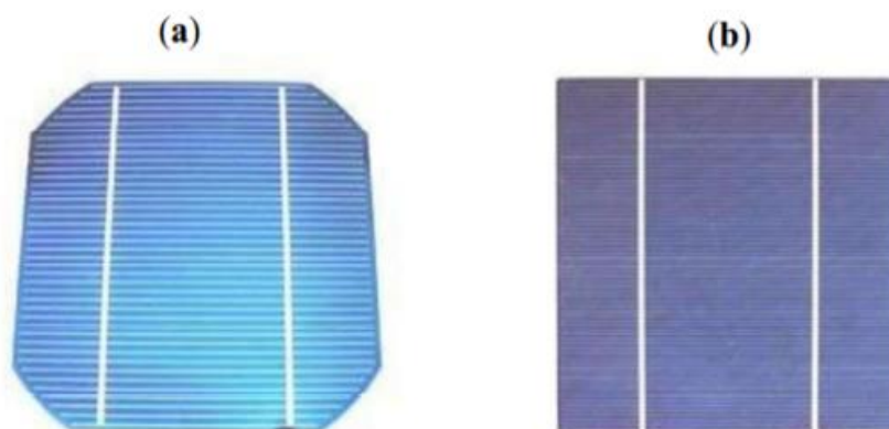
Figure I.2 : Cellule de première génération, monocristalline (a) et poly cristalline (b).
