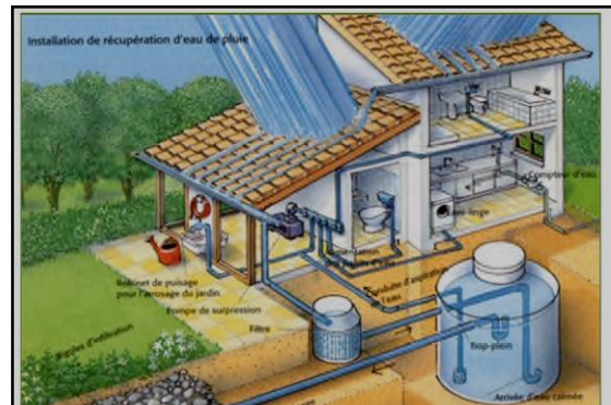
Fig. VI 45. Principe de la gestion d'eau. Source : www.Aquabion.com
