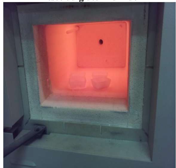
Four à moufle à 900° C plus les nacelles de quartz
