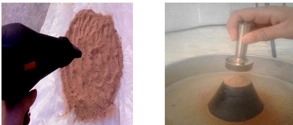
Figure II.7 : Essai d'absorption d'eau
