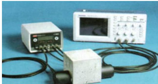
Figure I.18 : Appareil d'auscultation sonore avec oscilloscope
