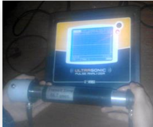
Figure II.17: Etalonnage de l'ultrason à l'aide du barreau
