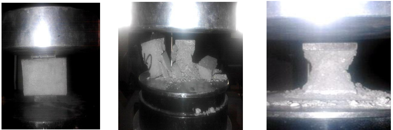
Figure II.15 : Eprouvettes après essai d'écrasement en compression simple
