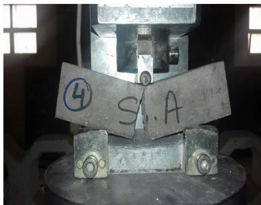
Figure II.13 : Eprouvettes après essai de flexion en trois points
