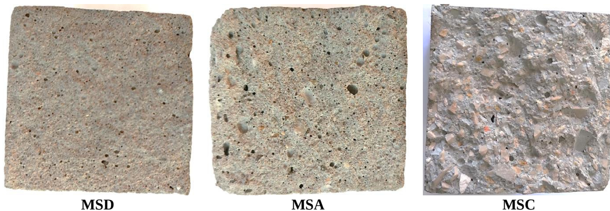
Figure III.4 : Etats de surfaces de la fissure des trois mortiers étudiés après essais de flexion
