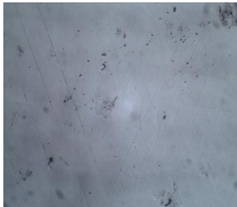
Figure 35 : Microstructure de la fonte polie (grossissement X500)
