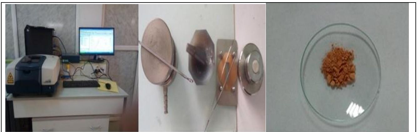
Figure 20 : Spectromètre infrarouge (laboratoire de physicochimie des matériaux LPCM– Laghouat)
