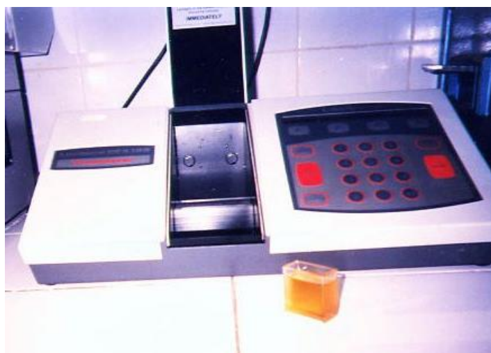
Figure (II-6) photographie de colorimètre pour la mesure de l'indice couleur [II.11].
