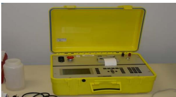
Figure (II.16) Appareil de mesure de tension de rétablissement au laboratoire ISOLIME. [II.14]
