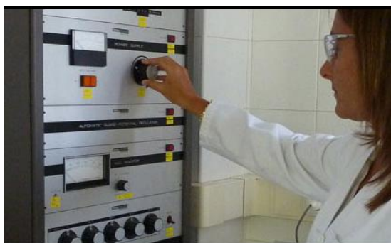
Figure (II.12) Cellule de mesure du facteur de dissipation diélectrique de papier isolant de laboratoire de la Société Rymoil S.A, spécialisé dans les huiles de transformateurs et les sols contaminés, Polígono Industrial Logrezana, 0 S N, 33438, Espagne [II.6]
