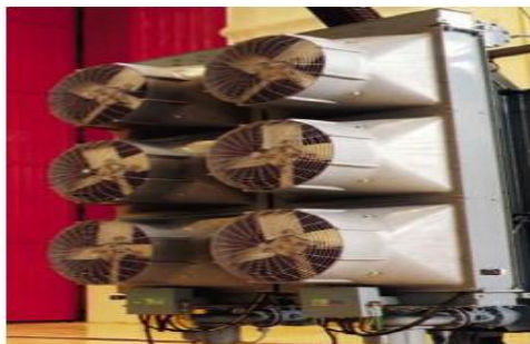
Figure (I.7) Aéroréfrigérant
