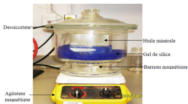
Fig. III.1. Technique de déshumidification et dégazage de l'huile
