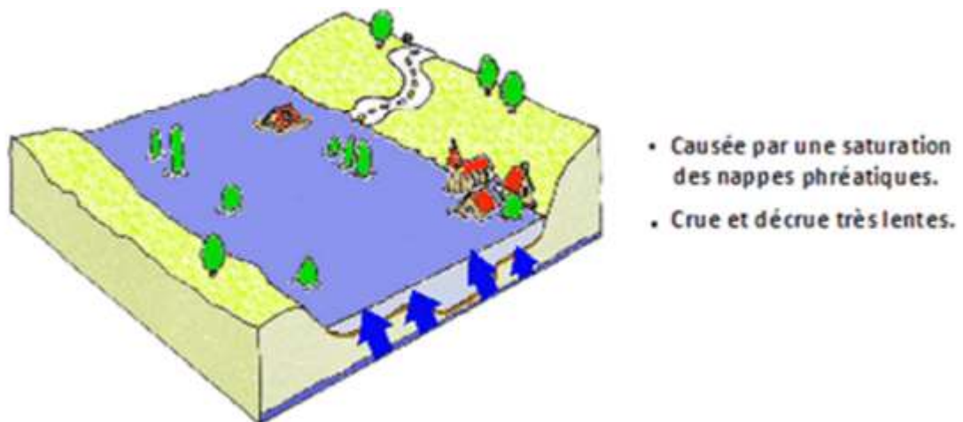
Figure 03 : Inondation par remontées des nappes phréatiques(Merabet ,2006)
