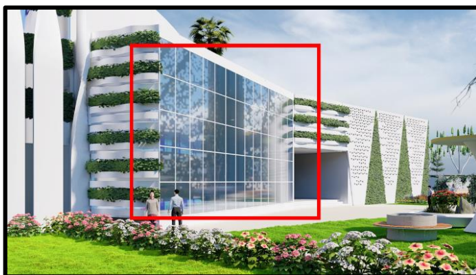
Figure V-36 : mur-rideau (façade nord) Source : l'auteur.
