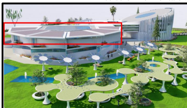
Figure V-37 : Brise soleil horizontale (façade sud) Source : L'auteur
