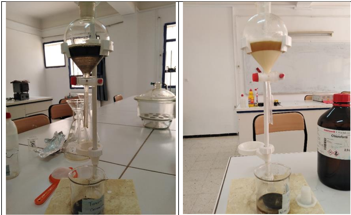
Figure 14 : Extraction liquide-liquide avec du chloroforme, (Cliché Original, 2024)
