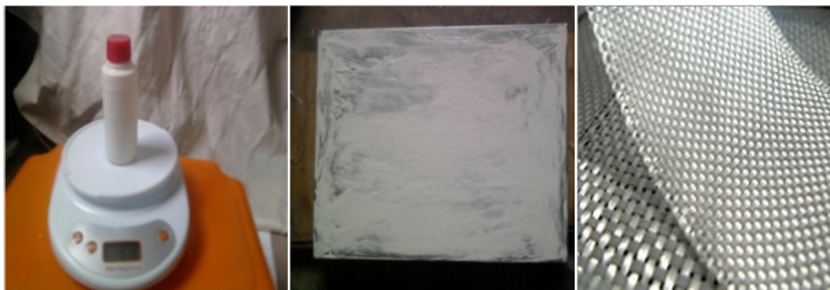
Figure II- 5 : Les éléments à préparer pour l'élaboration de notre composite: pesage du durcisseur, le moule pain par le gel-coat, la fibre de verre.
