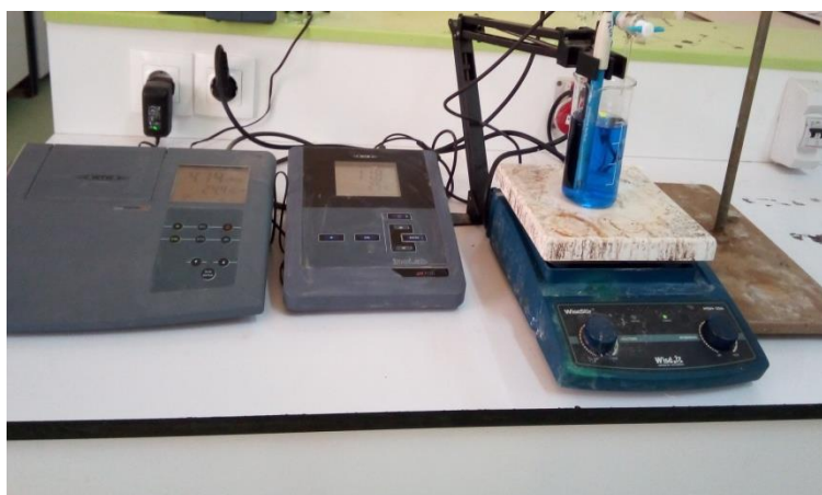
Figure n°9 : Protocol expérimental de pH-mètre et Conductimètre d'étude de la formation des complexes de (Co (II) -glycine, Cu (II)-glycine)
