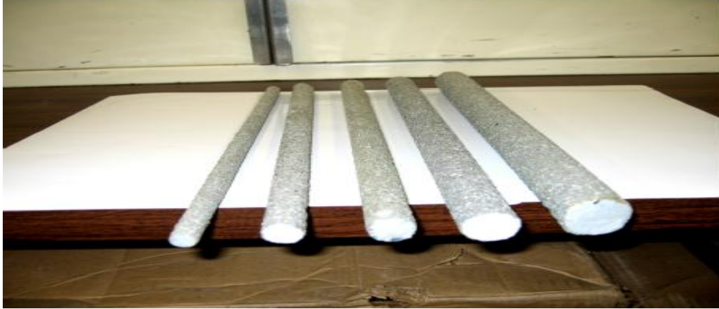
Figure III.2. Barres en PRFV de différents diamètres utilisés
