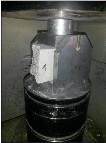
Figure II.19- Presse d'écrasement à la compression.
