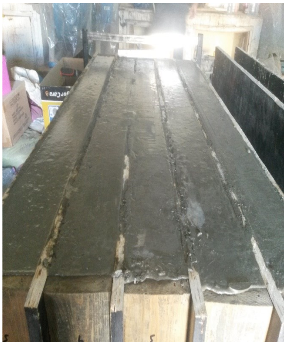
Figure II.21- Poutres en Béton de fibres.
