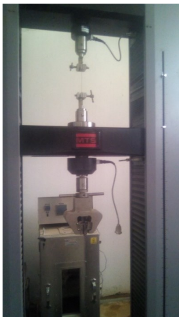
Figure II.14- Presse de traction de 5KN de capacité.
