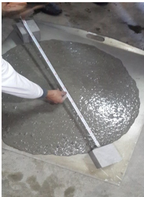
Figure II.17- Utilisation le cône d'ABRAMS pour la détermination de l'étalement.
