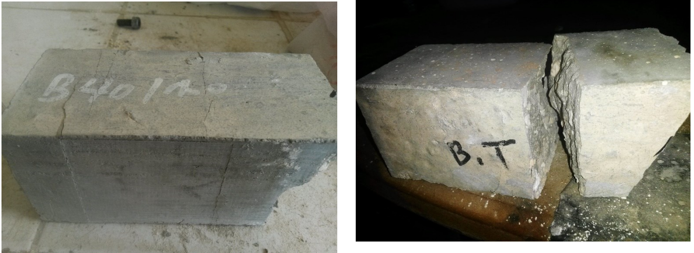
Figure III.3- Mode de rupture de BT et BL40P10
