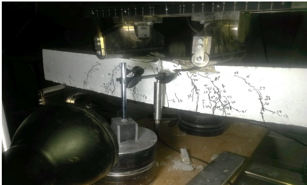
Figure II.22- Schématisation du dispositif de flexion 4 points.
