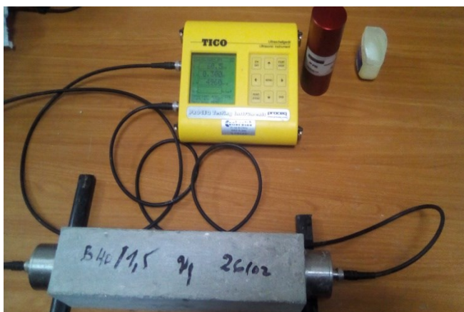
Figure II.18- Appareil d'Auscultation dynamique (ultra sonore).
