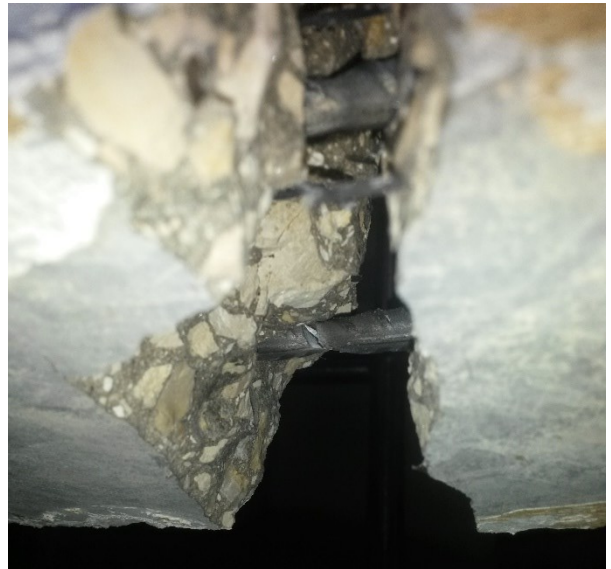
Écoulement d'acier de la poutre BCDF40
