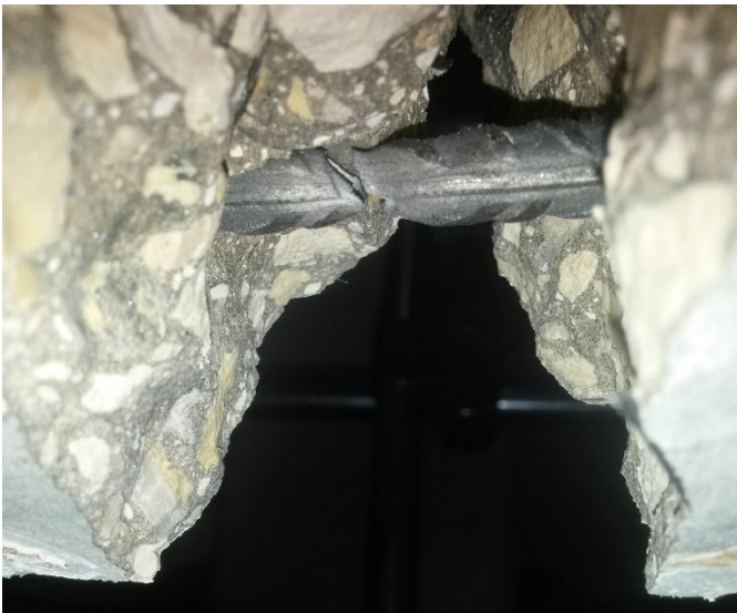
Écoulement d'acier de la poutre BCDF40
