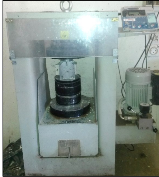
Figure II.19- Presse d'écrasement à la compression.
