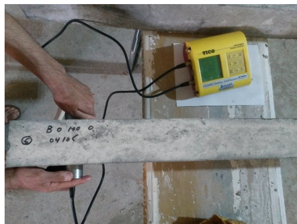
Figure II.18- Appareil d'Auscultation dynamique (ultra sonore).
