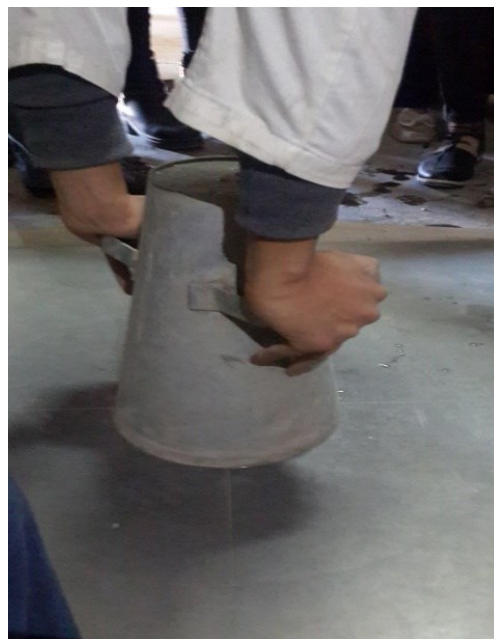
Figure II.17- Utilisation le cône d'ABRAMS pour la détermination de l'étalement.
