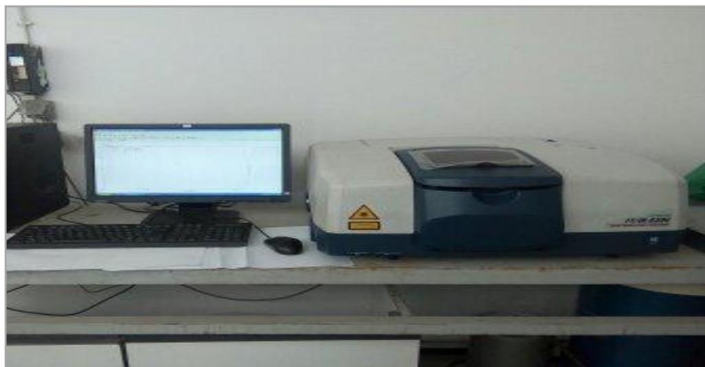
Figure II.9: Photographie de la spectrophotomètre d'absorption JASCO IRTF
