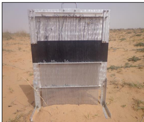
Figure 9 : Rugosimètre à aiguilles (cliché Djekidel S).
