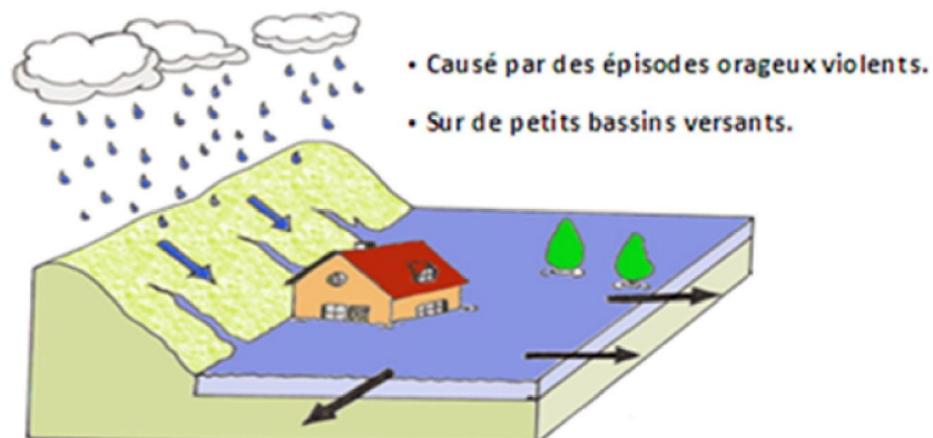
Figure I.7 : Inondation par ruissellement en secteur urbain. [8]
