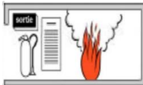
Figure 143 : Extincteurs mobiles au niveau des dégagements
