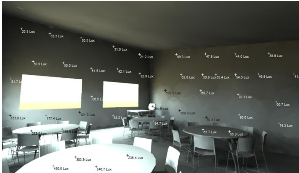
Figure 190: Mesure de niveau d'éclairément à ciel couvert. Source: auteur.
