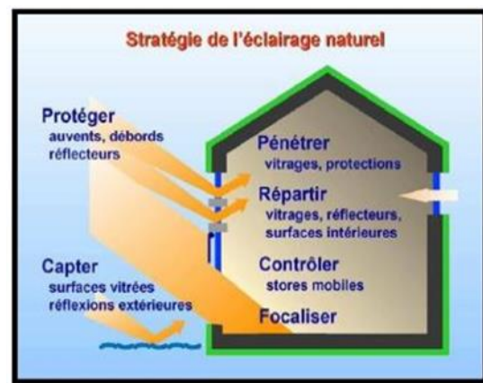
Figure 17 :Stratégie de l'éclairage naturel. Source : http://www.jan-maison-passive.com
