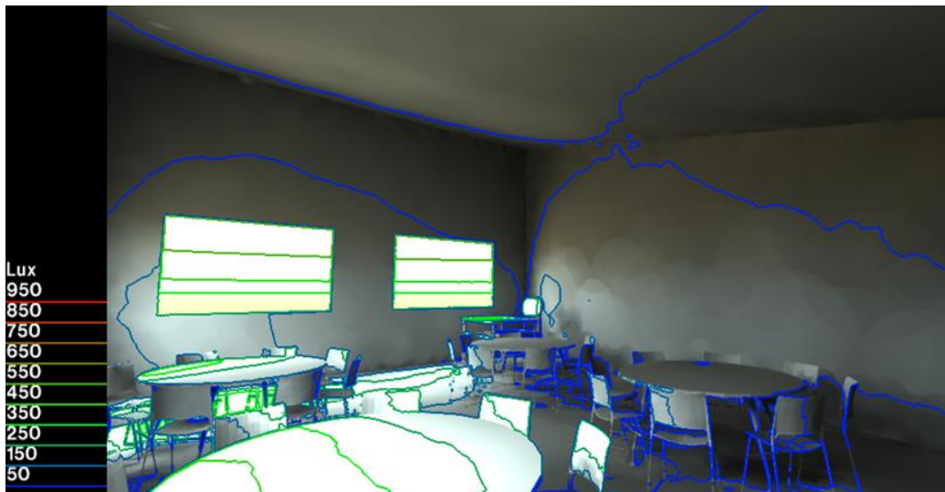
Figure 191: courbe iso à ciel dégagé. Source: auteur.
