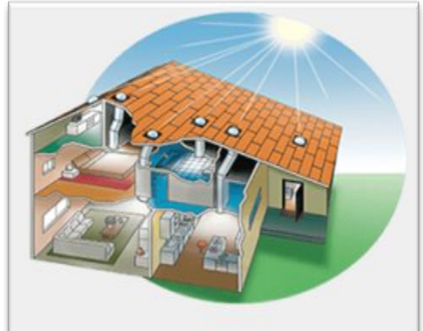
Figure 34: puits lumière de Groupe Scolaire Simone Veil .Source : TEKHNE ARCHITECTURE.
