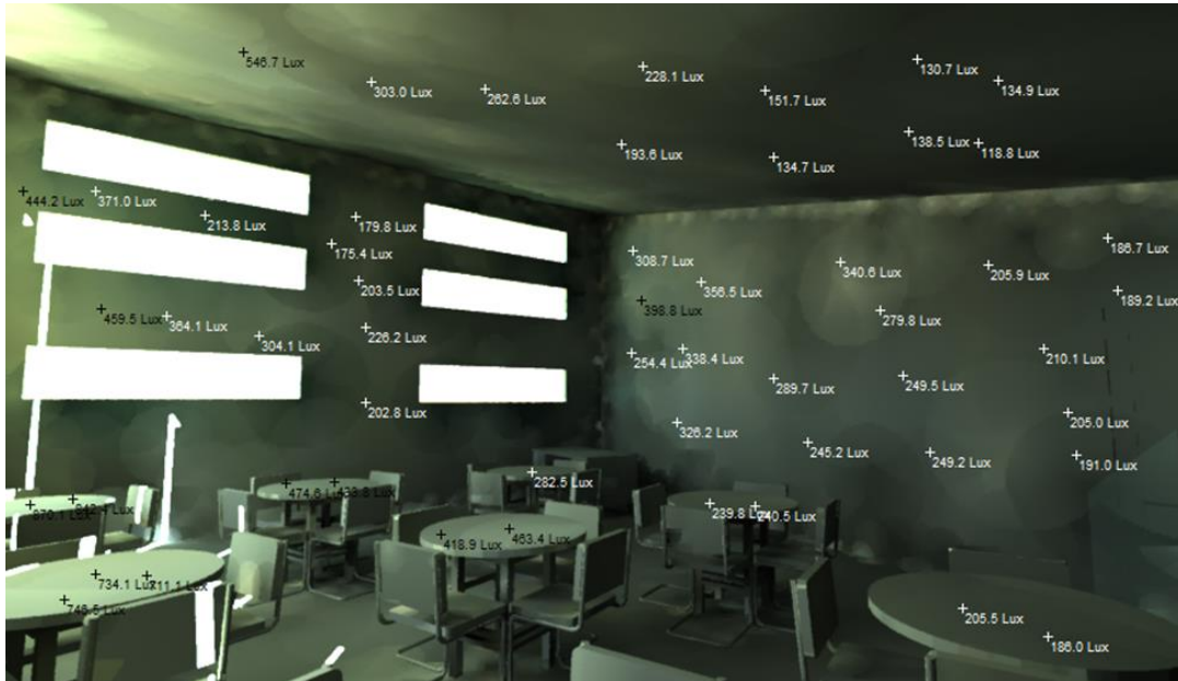
Figure 205: Mesure de niveau d'éclairage à ciel dégagé. Source: auteur.
