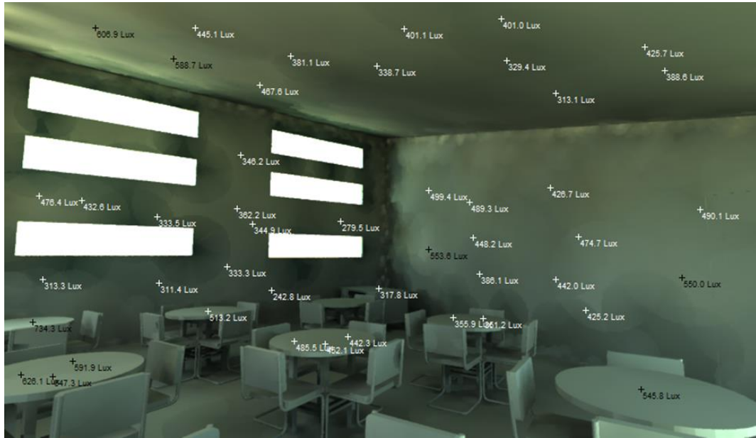
Figure 207: Mesure de niveau d'éclairage à ciel dégagé. Source: auteur.
