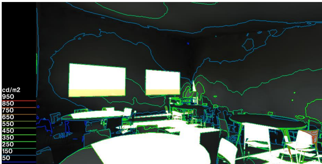
Figure 197: : courbe iso à ciel dégagé. Source: auteur.
