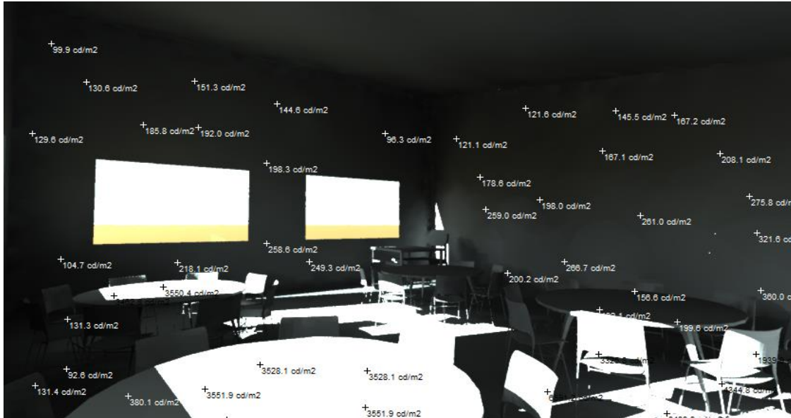
Figure 196: Mesure de niveau d'éclairage à ciel dégagé. Source: auteur.
