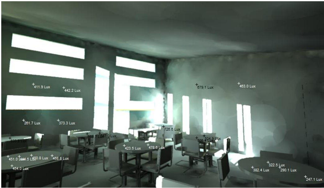
Figure 201: Mesure de niveau d'éclairage à ciel dégagé. Source: auteur.
