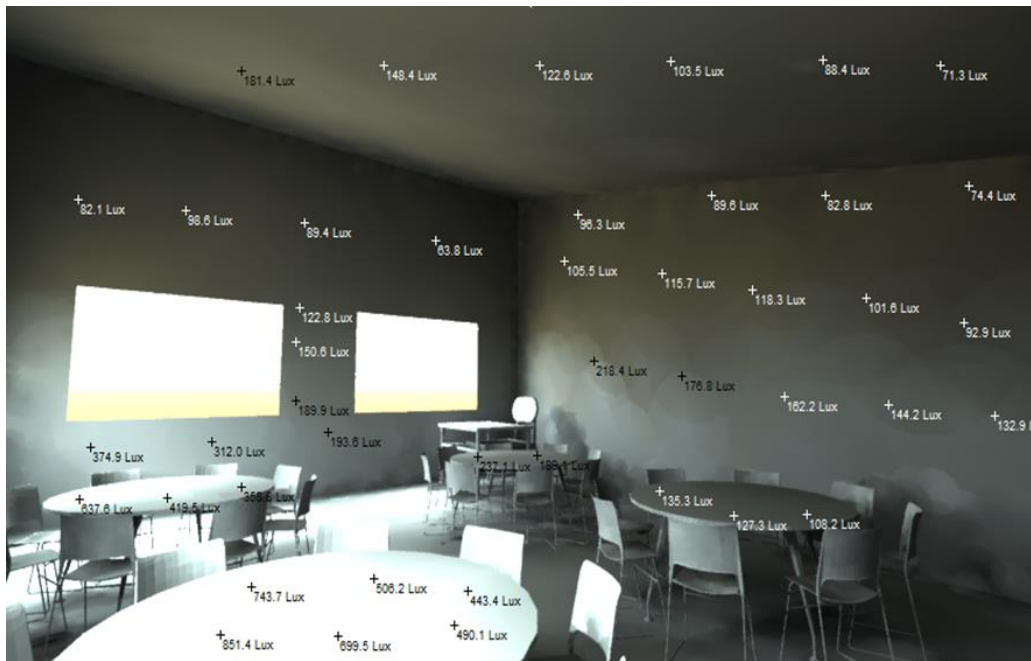
Figure 192: Mesure de niveau d'éclairément à ciel couvert .Source: auteur.
