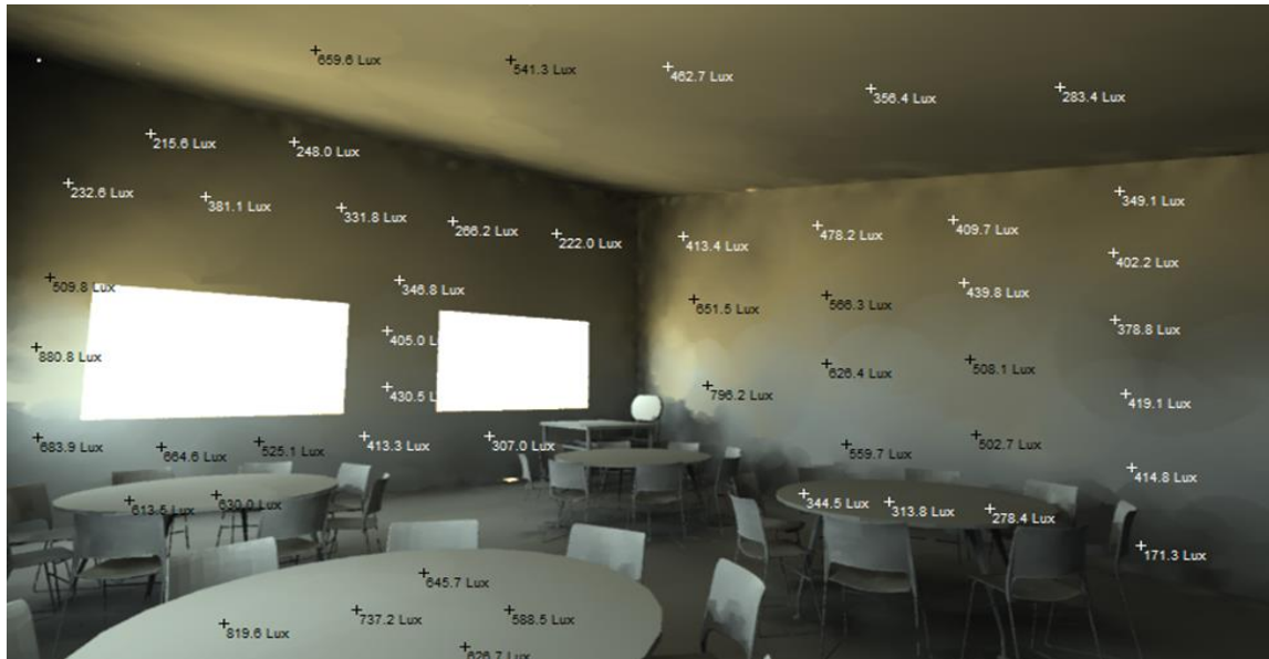
Figure 194: : Mesure de niveau d'éclairage à ciel dégagé. Source: auteur.
