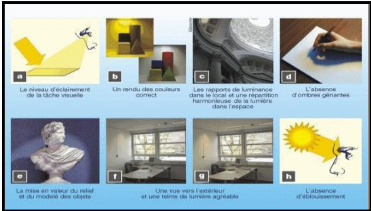
Figure IV.21 : Paramètres du confort visuel, Source : Revue CSTC; Le confort visuel et la normalisation
