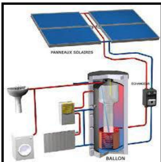
Figure IV.48 : Système de capteur thermique Source: maison passif l'énergie solaire
